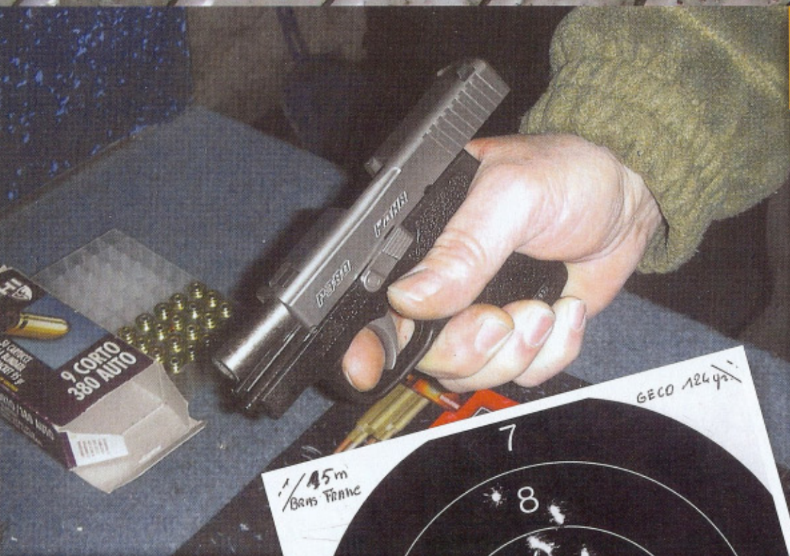
La cible tirée par Jean-Pierre à 15 mètres avec le Kahr "K9" (H 110 x L 35 mm sur centres). Cartouches Geco à balles blindées de 8 g. Remarquer le centrage parfait et la dispersion verticale résultant du recul.
