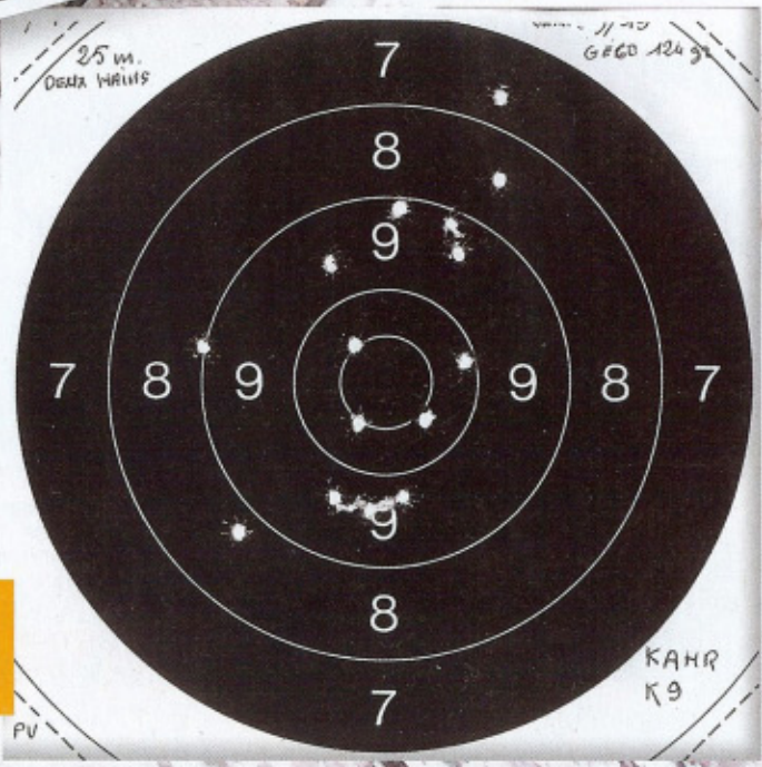
La cible tirée à 25 mètres par Jean-Pierre avec la même arme, mais à deux mains (H 117 x L 79 mm sur centres). Mêmes munitions. Le centrage est toujours aussi bon, mais la dispersion s'accroît en fonction de la distance.
